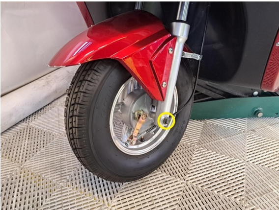
Irrota etuakseli (kiintoavain 14 mm) vastamutteri. (kiintoavain 17 mm).
