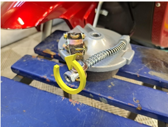
Irrota etujarruvaijerin säätömutteri. (kiintoavain 14 mm).
