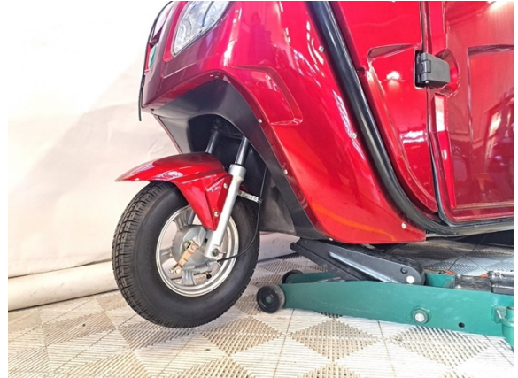
Nosta Autokruiserin etuosa ilmaan. (tunkki).
